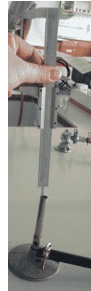
استخدم مقياس عمق الفرجار كما هو موضح
